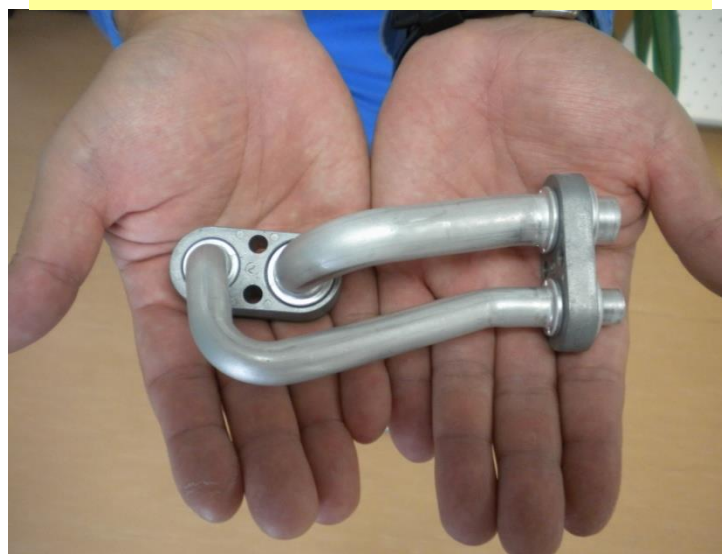
エバポレーターパイプ
